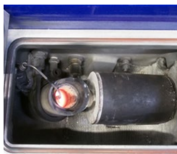
細い箇所が設けられているディテールの凝ったデザインの場合、真空または遠心鋳造法を採用した方が鋳型を埋めやすくなります。
